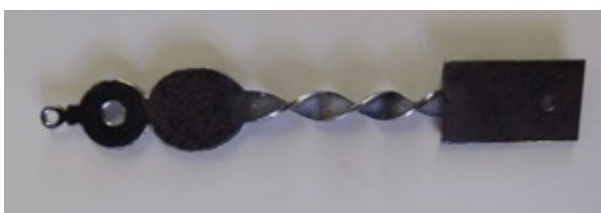
De ruwe vorm van de klamparm met torsing en sluitoog.
