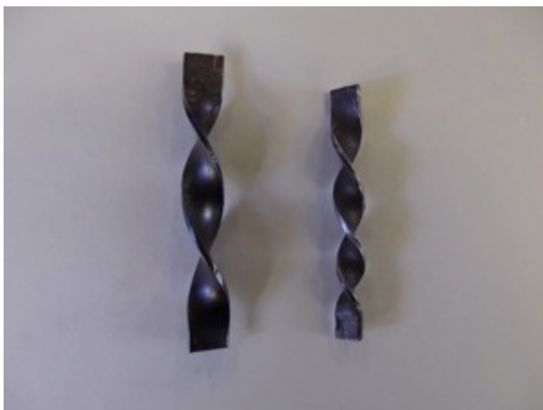
Proeven om de vorm van torsing te bepalen.
