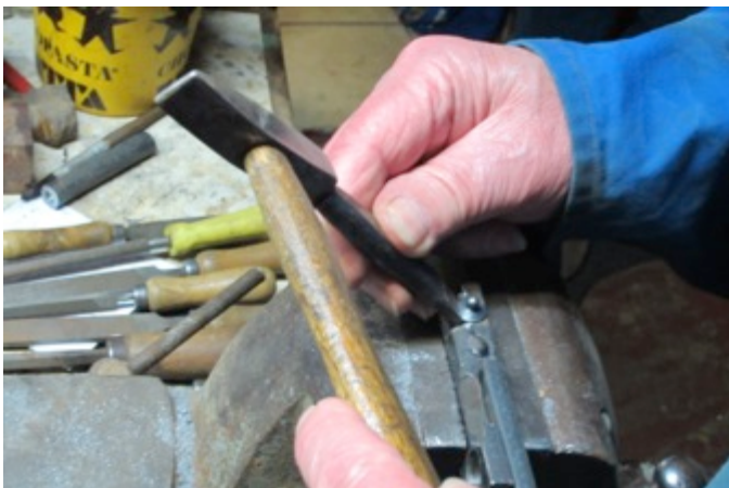
Het schuin kloppen van de grondplaat van de sluitknop.
